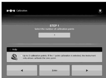
3. 取出样品室内的试管，点击 ◀/▶ 键直至视场出现均匀一致的光亮，点击 **Enter** 键完成零点校准。
